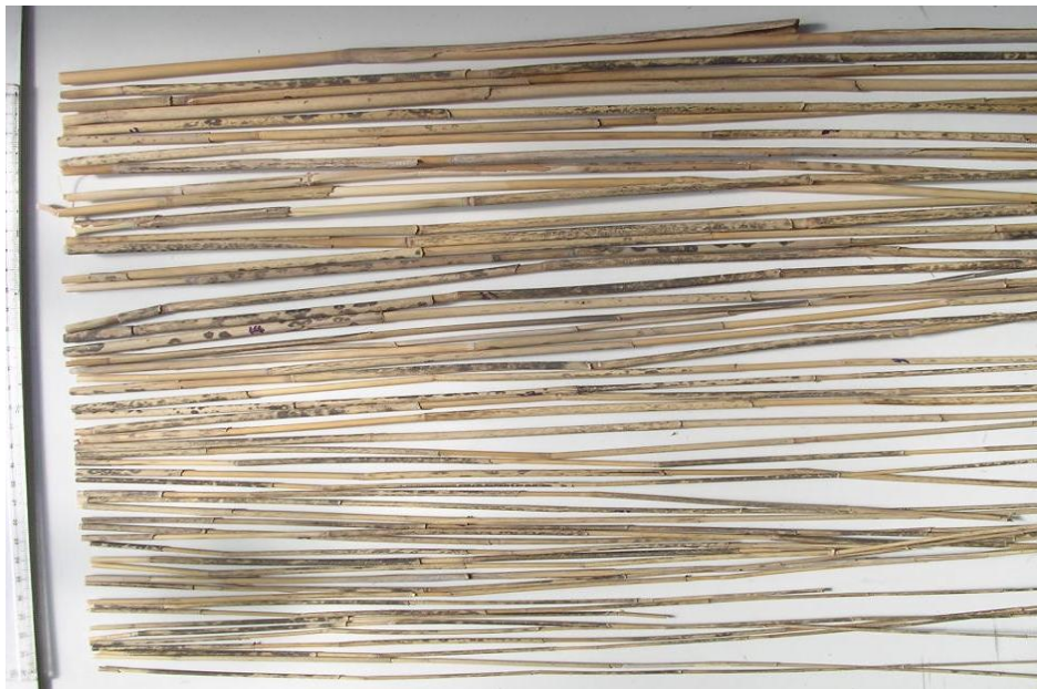
Abb.12. Halmproben 8, Ausmaß der Schwärzung, 0 - 80 cm
