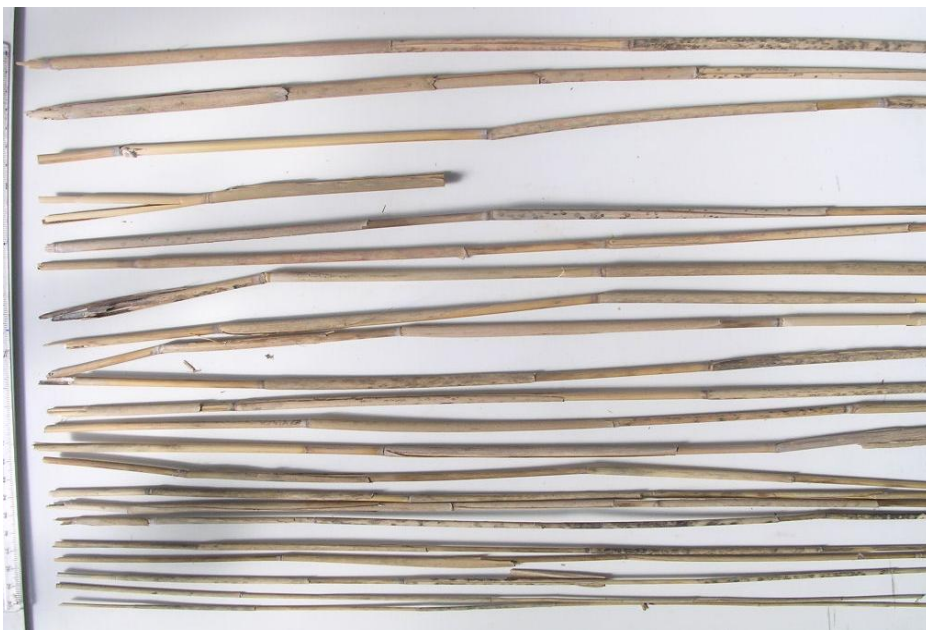
Abb.8. Halmproben 4, Krummrohr, Feinreet unten, Halmbereich 0 - 80 cm
