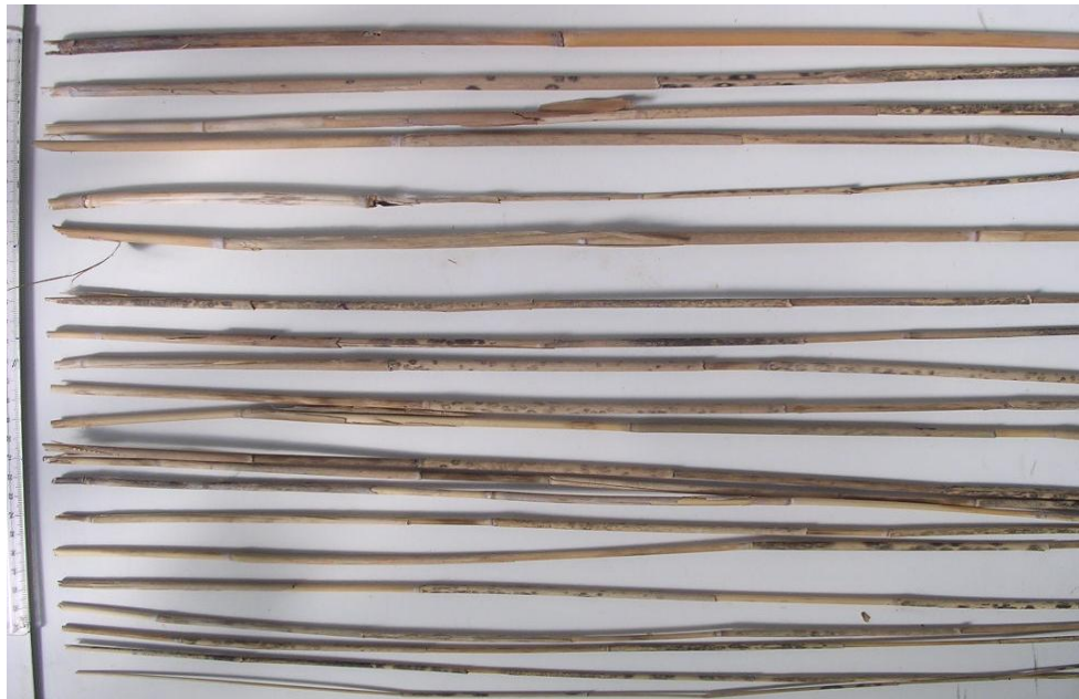
Abb.6. Halmproben 2, Schwärzungen, unten Feinreet, Halmbereich 0 - 80 cm.
